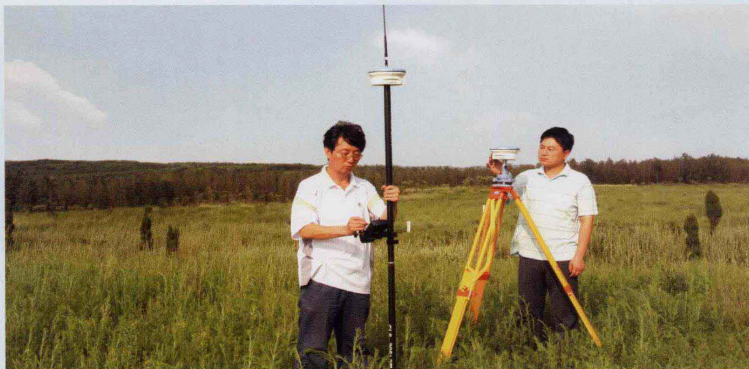
公路测量设计人员采用GPS卫星定位测绘仪器进行野外测量作业
