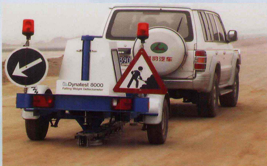
公路路基弯沉检测
