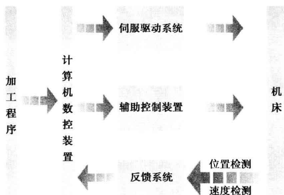
图 1-2 数控机床的工作原理图
