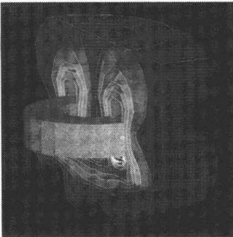
本图是用 ANSYS 的电磁分析功能分析电极板的例子,它用一个特定的单元将矢量场和标量场联系起来,并借助三维图形的形式用无限边界元描述远端电磁场的衰减。图中用等值线描述了电磁场(H 场)的强度
