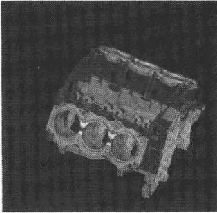
这是一个使用 ANSYS 热传导功能分析 V6 发动机的例子,曾由代表美国汽车工业的 Analysis & Design Appl. Co. Ltd. (ADAPCO)公司负责实施,它使用 ANSYS 改善了汽车发动机的性能。发动机中的热应力线如上图所示
