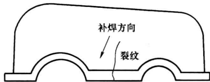
图 1-4 减速箱上盖裂纹
