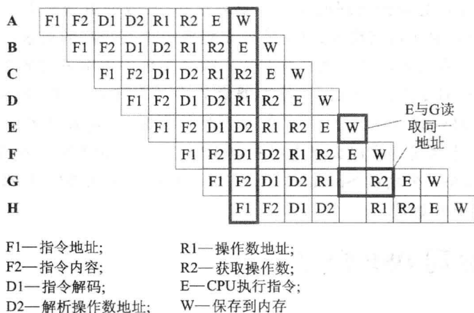
图 1-1 TI 公司 F2833x 系列 DSP 的 8 级流水线
