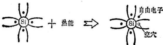
图 14-2 热激励产生的电子空穴对
