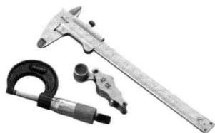
| 京瓷创业时使用过的量具。特别是放大镜，一定会带到现场，仔细观察产品，对问题点进行彻底的观察思考，这已成为惯例。
