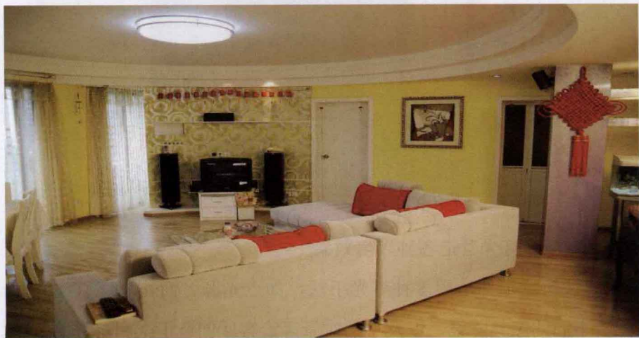
图1—13 圆形顶棚能增大室内空间效果, 又能满足经济性要求
