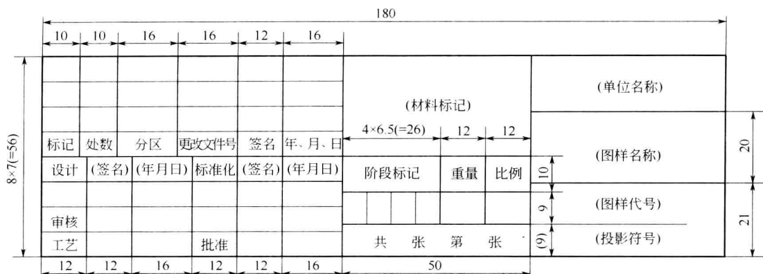
图 1-11 标题栏的格式及尺寸（参考画法）
