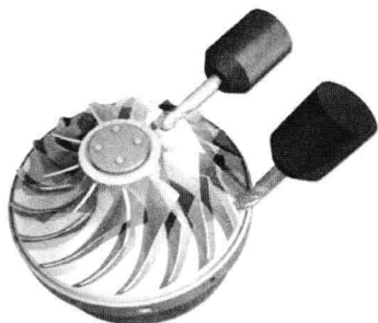
图1-10 整体叶轮零件五轴联动加工
