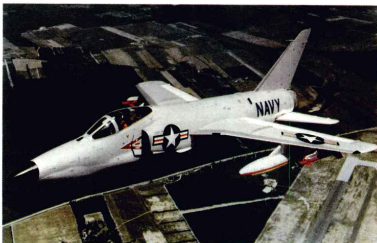
左图：在第42架“虎”式飞机下线之后，在后来的飞机上引进了较长的机头，在机头里面放置雷达。但是，这种机头从来没有被安装过。
