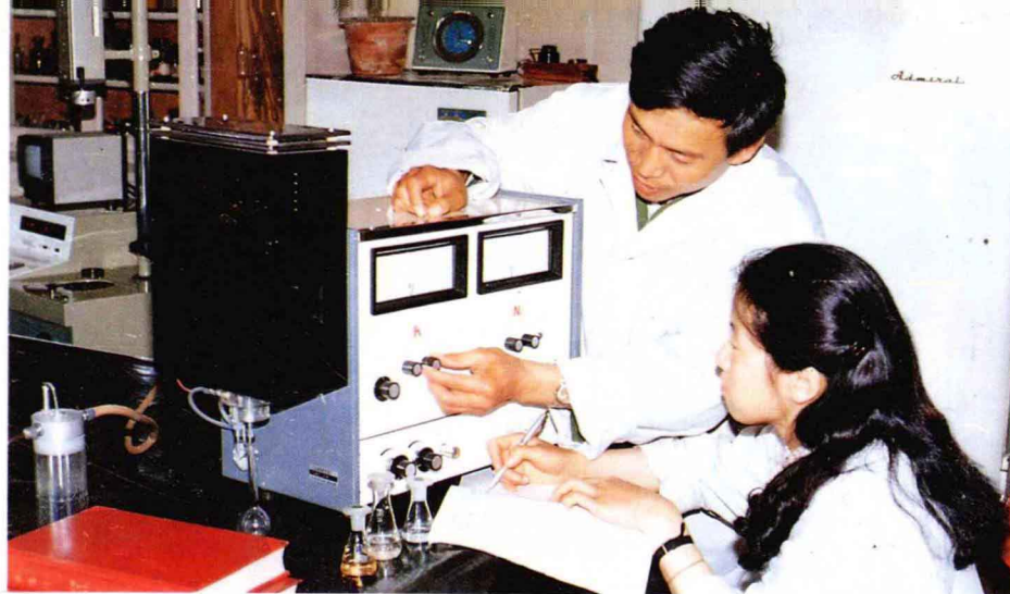
吉林省药检所用 火焰光度计测定青霉 素钾离子浓度
