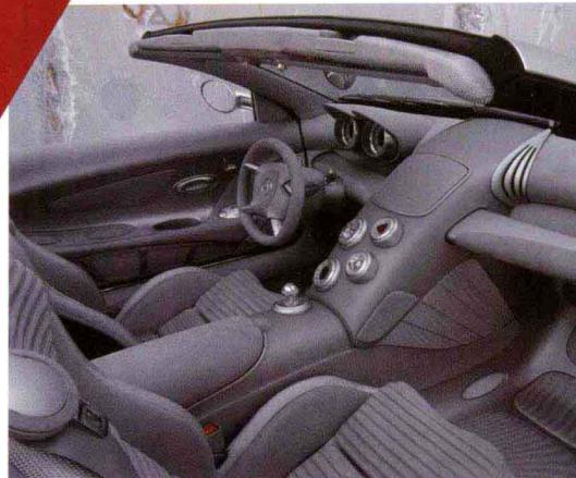
在1999年的北美车展中从奔驰展台上上升起了一颗耀眼的银色之星, 它就是奔驰Vision SLR。这车外形上来自F1灵感的车鼻、修长的发动机盖、强壮有力的翼子板和蝶翼形车门脱胎于奔驰20世纪50年代传奇的SL型车和赛车版SLR, 尾部短促有力, 整个外形饱满而充满动感, 内饰尽显豪华和未来感, 一时间成为众人心中的梦幻之车。车身广泛应用碳纤维材料, 与传统钢结构车身相比可减轻40%的重量。制动系统采用了电子液压制动系统, 这是在两门跑车中第一次使用该技术。另外还有一项创新技术: 碳纤维增强陶瓷制动盘, 它能经受超负荷的考验。
