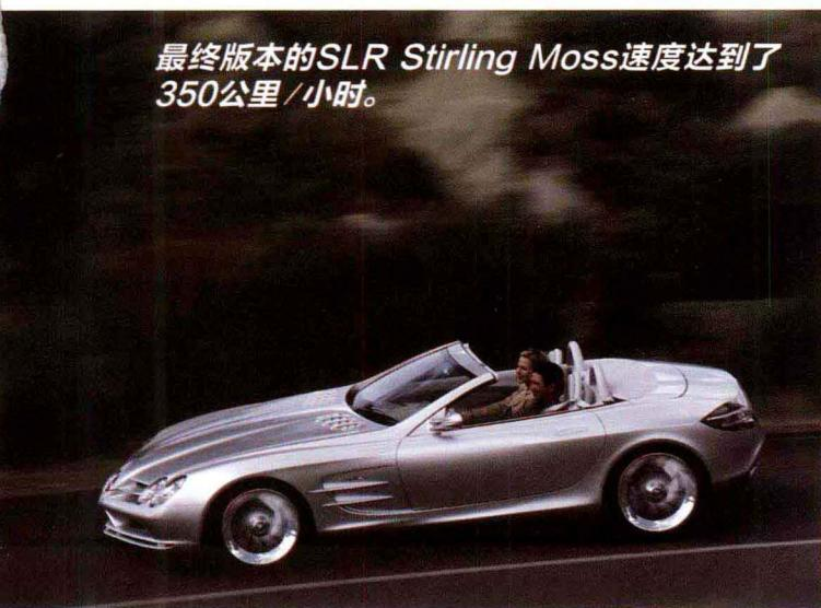
在Vision SLR修长的发动机盖下隐藏着一台排量为5.5升的机械增压V8发动机, 最大输出功率为415千瓦, 最大转矩为720牛·米, 在4.2秒内就可以从0加速到100公里/小时, 最高速度则达到惊人的320公里/小时。
