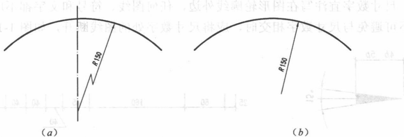
图 1-15 大圆弧半径的标注
