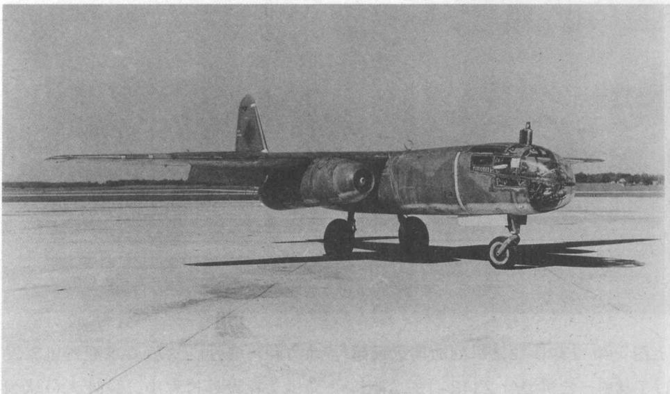
上图：这架被俘获的飞机是这种飞机的主要生产型Ar 234B-2飞机。座舱上部的部件是一个潜望镜式瞄准仪，该瞄准仪可供两门选装的0.79英寸（20毫米）后向射击机炮使用，或者供飞行员观察自己飞机的尾部情况时使用。
