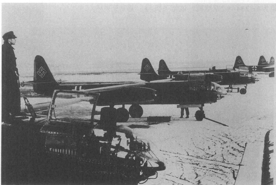
机最初仅限于进行滑行试验。后来，当第一套获准投入飞行试验的发动机交付之后，直到1943年6月，原型机才开始实施了首次飞行试验，当时配置的发动机为“朱姆”109-004A型，每台推力为1852磅（8.24千牛顿）。在飞机实施测试与发展的过程中，使用的原型机达到18架之多，通过这些不同的原型机，设计人员对新型轰炸机的不同特征进行了评估。
