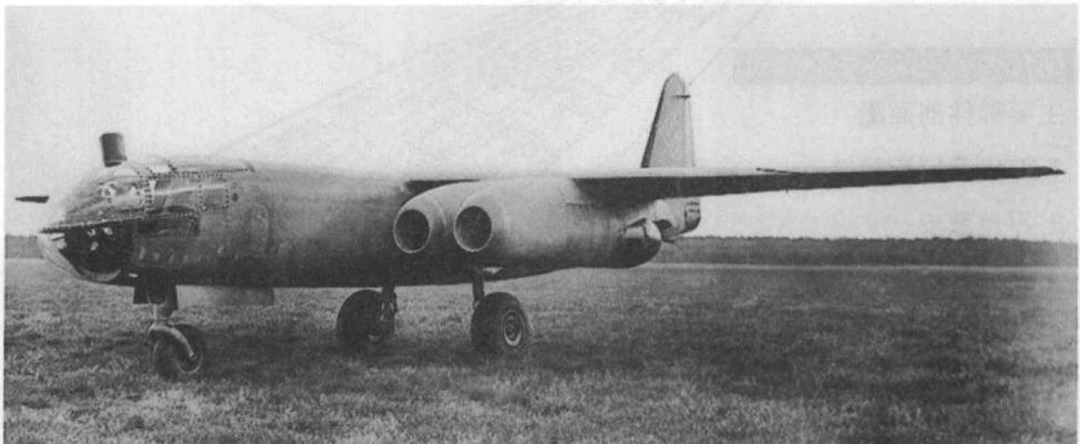
率问题的影响，性能提升受到制约。在配置高功率动力装置后，尽管飞机性能并不会有太大提高，但此时飞机可以携带更多战斗载荷，或者可以携带更多燃油量。分别有两架Ar 234A系列原型机加装该种改良型配置的动力装置：第一架为Ar 234-V8，于1944年2月进行首次试飞，4台发动机各放置在4个独立的发动机舱内；第二架为Ar 234-V6，于1944年4月进行了首次试飞，4台发动机分别放置在两个双发动机发动机舱内。后来，经过试验证明，双发动机机舱的配置更为有效，因此，设计人员将该种配置方式应用在最终推出的Ar 234C系列原型机上，后者配置了伸缩式前三点式起落架装置。具备了上述配置的原型机为Ar 234-V13和Ar 234-V15。这两架原
