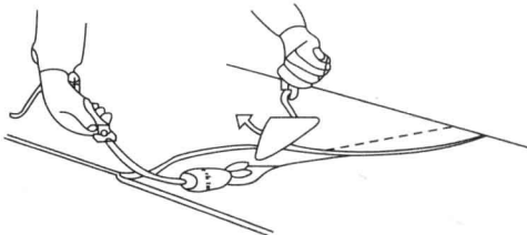
图 1-3 搭接缝熔焊粘结示意图
