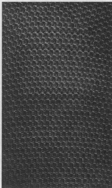
图 1-2 微流控技术制备的微泡沫 [2]
