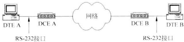
图 1-3 利用 RS 232 进行串行通信的典型示意图
