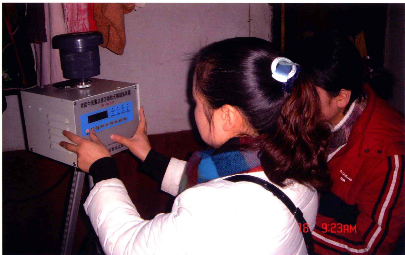
■ 为掌握病区室内空气氟污染水平，地方病防治专业人员现场采集农户家中空气样品。
