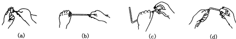
图 1-1 玻璃管与塞子连接时的操作方法
