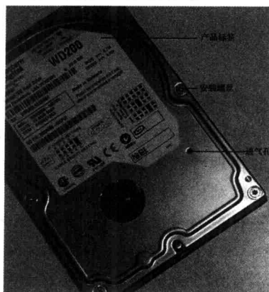
图 1-3 硬盘的透气孔
