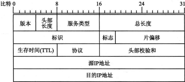
题 47-b 图 IP 分组头结构
