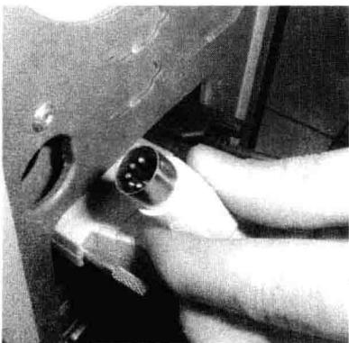
在音箱拿开以后,接下来就是拔键盘和鼠标线。键盘线一般都插得比较紧,需要稍微用些力气才可以拔下来。仔细观察一下键盘的接头,是不是觉得有点门道?没错,接口里面的针是有方向的,主板上的插口位置与它也相对应。在往回装的时候,用户一定要记得这个特点。
