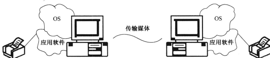
图 1-4 通过传输媒体直接连接构成的简单网络
