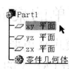
图 1-4 CATIA 模型树选中【xy 平面】
