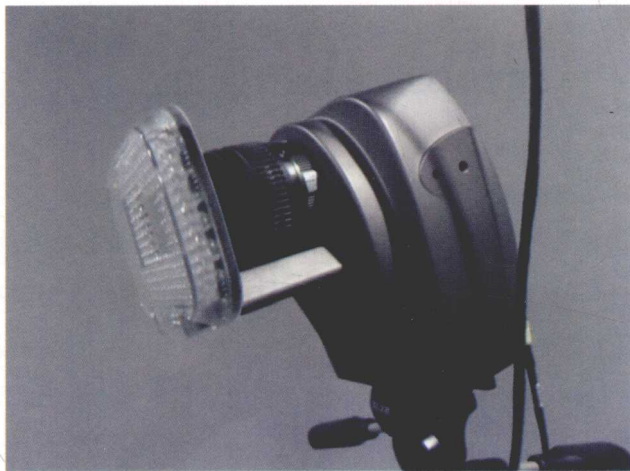
图1-7 光学 Motion Capture 系统的信号捕捉设备
