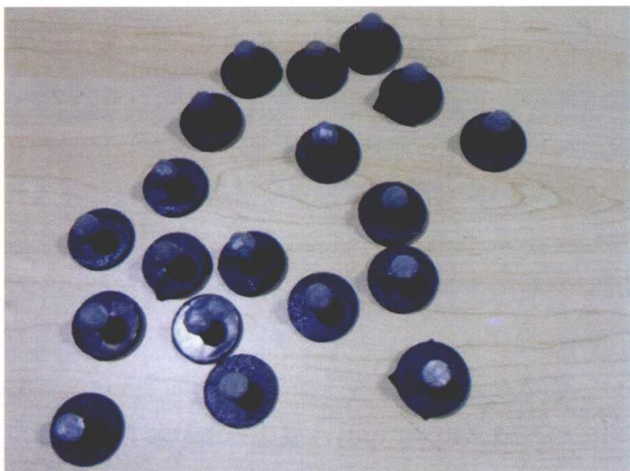
图1-6 被动光学动作捕捉系统的传感器
