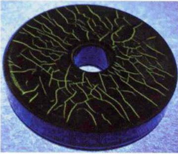
图 69 钢工件上的磨削裂纹 (荧光磁粉检测显示)
