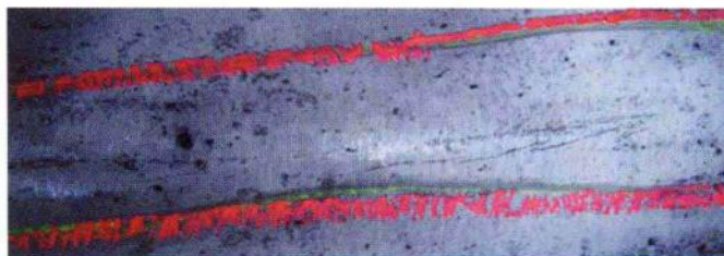
图 100 钢棒上的发纹 (黑磁粉检测显示)
