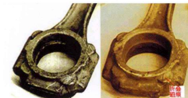
图 81 45#钢汽车连杆模锻件折叠 (黑磁粉检测显示)
