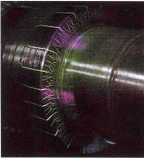
图 71 钢轴磨削裂纹 (荧光磁粉检测显示) [6]
