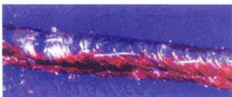
图84 对接焊缝上的纵向裂纹和弧坑裂纹（荧光磁粉检测显示）
