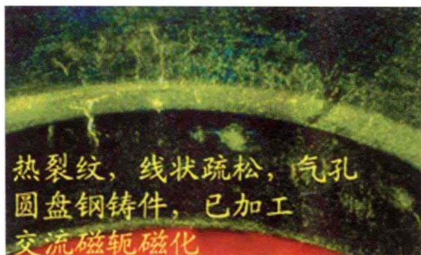
图106 铸钢圆盘热裂纹、疏松、气孔（荧光磁粉检测显示） [6]
