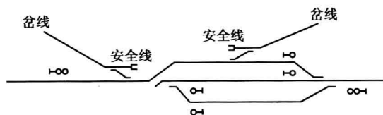
图 1-2 岔线在站内与正线、到发线接轨
