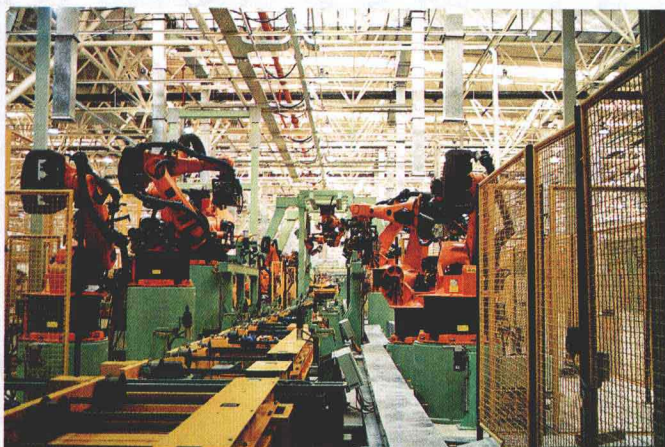
机械工业部第四设计研究院设计的华晨中华轿车项目焊装生产线
