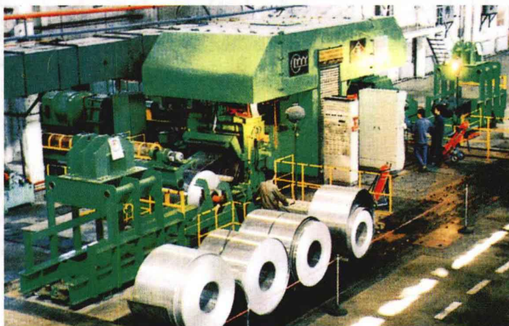
洛阳有色金属加工设计研究院1400毫米全液压不可逆铝带冷轧机
