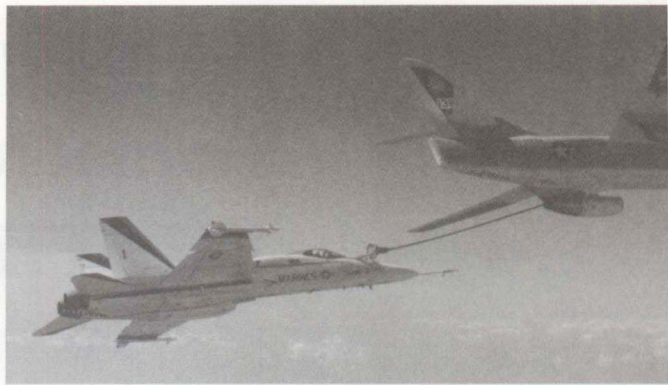
上图：舰载空中加油机使海军的攻击半径大幅增加。这对于航程短的F/A-18尤其有效。20世纪80年代初，图为首架“大黄蜂”与一架KA-3B“天空武士”加油机在派往海军空中测试中心途中进行空中加油测试。
