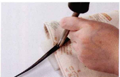
28 用铆钉固定棒以铁锤敲打固定。
