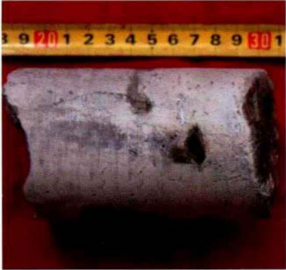
图 1-5 塔河油田 BS147 井溶蚀孔洞 沿溶蚀缝发育，零星分布，孔径 3 ~ 10mm，方解石半充填
