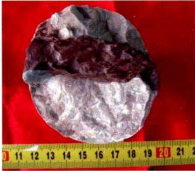
图 1-2 轮南油田 BN140 井古岩溶现象 图中灰绿色砂泥质充填缝为海西早期古岩溶， 紫红色泥质充填缝为海西晚期干旱 环境下风化壳古岩溶
