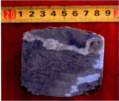
图 1-3 塔河油田 BT502 井古岩溶现象 图中白色方解石充填缝为早期古岩溶， 灰绿色砂泥质充填缝为海西早期古岩溶
