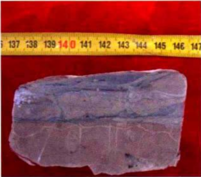
图 1-1 塔河油田 BT702 井古岩溶现象 图中白色方解石充填缝为早期古岩溶， 灰绿色砂泥质充填缝为海西早期古岩溶
