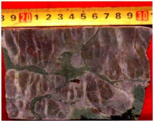
图 1-7 塔河油田 BS179 井溶蚀缝（缝宽 1 ~ 5 mm）
