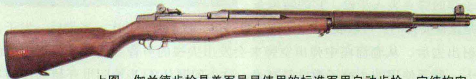
上图：伽兰德步枪是美军最早使用的标准军用自动步枪。它结构牢固，结实耐用。气动操作的M1步枪和它的前任——使用枪栓装置的M1903斯普林菲尔德步枪相比重了一些。
