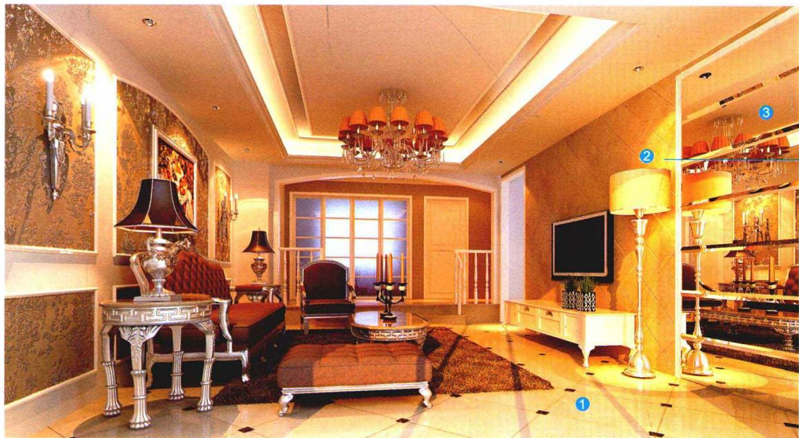
» 电视背景墙面用水泥砂浆找平，然后用湿贴的方式将同规格的仿古砖斜拼固定在墙面上。剩余墙面用木工板打底，用粘贴固定的方式将银镜固定在底板上。
