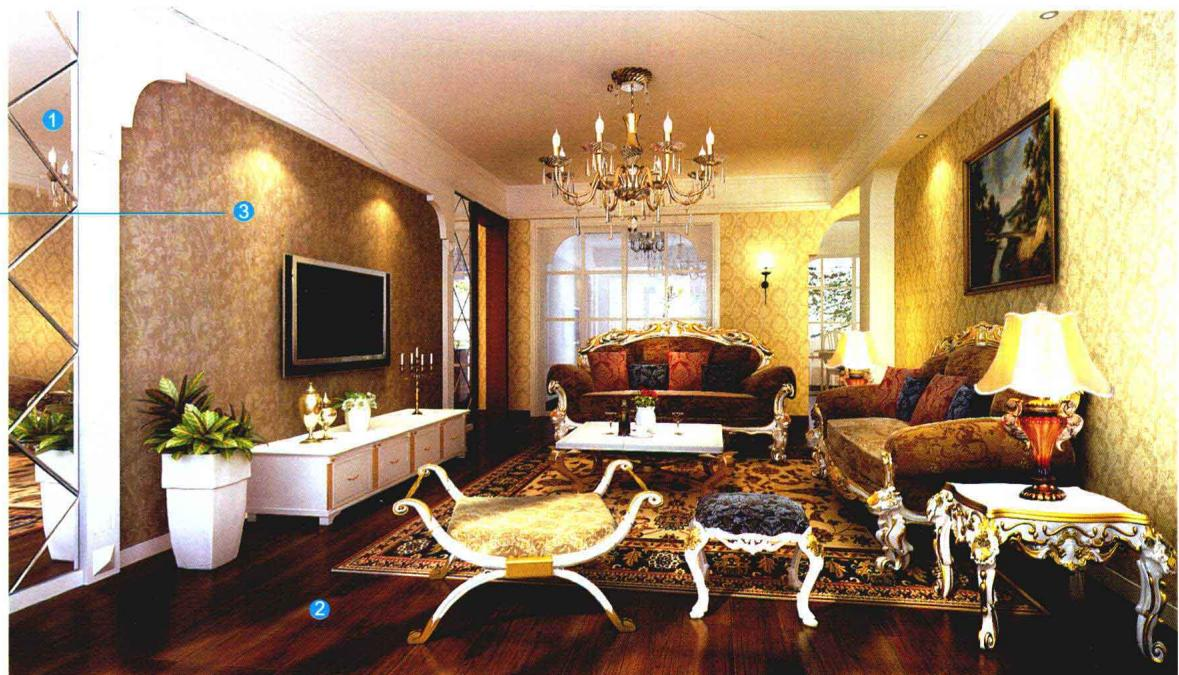
» 按照设计图用木工板做出弧形造型，整个墙面满刮腻子，用砂纸打磨光滑，刷一层基膜，用环保包乳胶配合专业壁纸粉将壁纸固定在墙面上。用玻璃胶将银镜固定在底板上。
