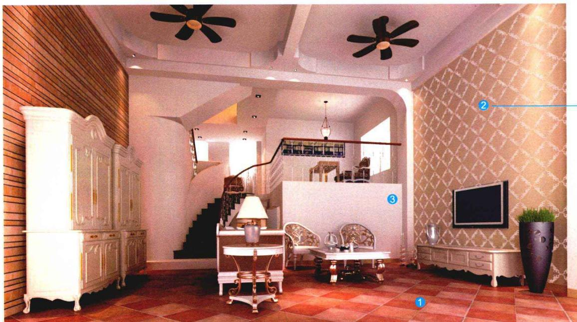
» 电视背景墙面用水泥砂浆找平，整个墙面满刮三遍腻子，用砂纸打磨光滑，刷一层基膜，再用环保白乳胶配合专业壁纸粉将壁纸固定在墙面上，最后安装实木踢脚线。
