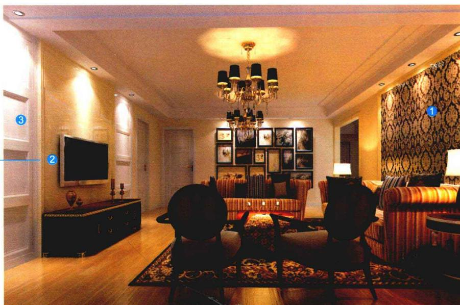
» 在背景墙面上弹线放样，用湿贴的方式将仿古砖固定在墙面上，用勾缝剂填缝。用木工板做出两侧对称造型后满刮腻子，打磨光滑，刷底漆、面漆，用环保白乳胶将壁纸固定在墙面上。
