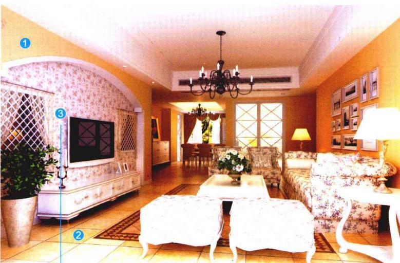
» 用木工板及硅酸钙板在墙面上做出凹凸造型，收边线条贴水曲柳面板后刷油漆。整个墙面满刮三遍腻子，用砂纸打磨光滑，刷底漆、有色面漆；用环保白乳胶配合专业壁纸粉将壁纸固定在墙面上。
