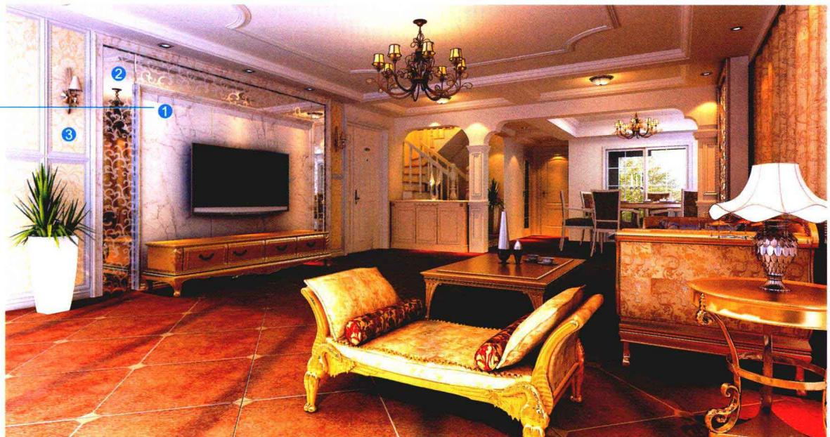
» 电视背景墙用水泥砂浆找平，用木工板做出两侧对称造型，整个墙面满刮三遍腻子，用砂纸打磨光滑，刷底漆、面漆；用环保白乳胶配合专业壁纸粉将壁纸固定在墙面上。
