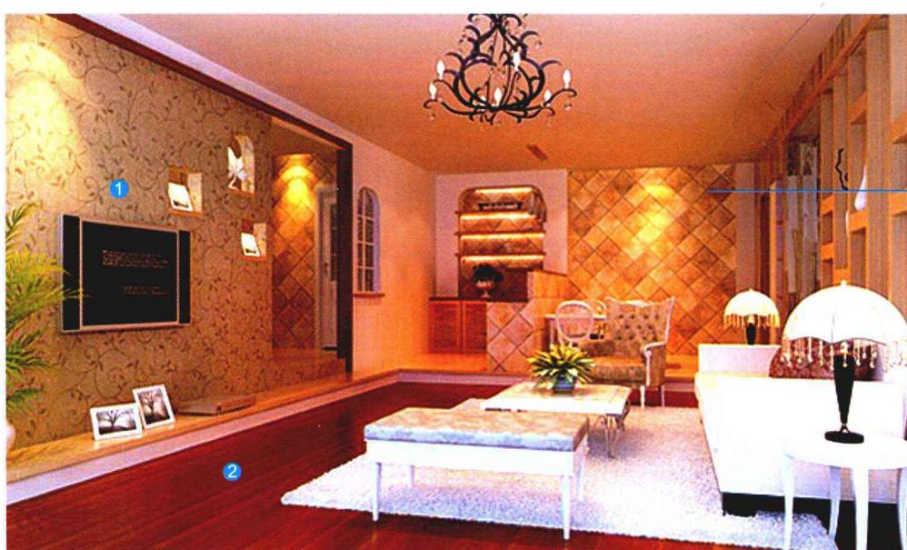
» 电视背景墙面用水泥砂浆找平,用木工板在墙面上做出收边线条,贴装饰面板后刷油漆。剩余墙面满刮三遍腻子,用砂纸打磨光滑,刷一层基膜后贴壁纸。顶部墙面刷底漆一遍、面漆两遍。
