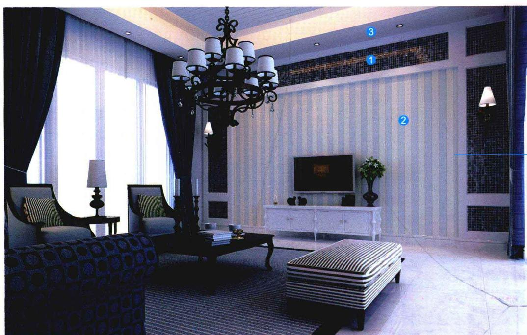
》》用大理石粘贴剂将马赛克固定在电视背景墙面上，用勾缝剂填缝；用木工板做出设计图上造型，墙面满刮腻子，用砂纸打磨光滑，刷底漆、面漆，刷一层基膜后贴壁纸；最后安装踢脚线。
