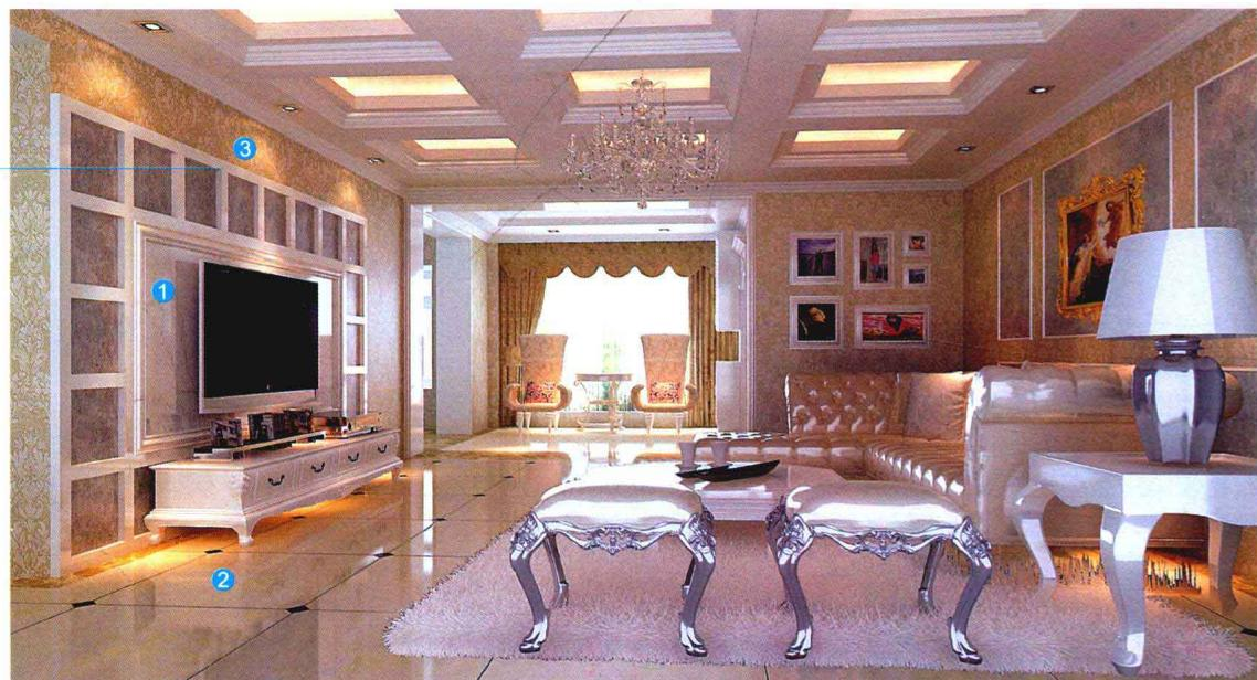
» 按照设计图纸在电视背景墙面上弹线放样，用点挂的方式将爵士白大理石固定在墙面上。剩余墙面用木工板做出格子造型，贴装饰面板后刷油漆，剩余墙面满刮腻子，打磨光滑，刷一层基膜后贴壁纸。
