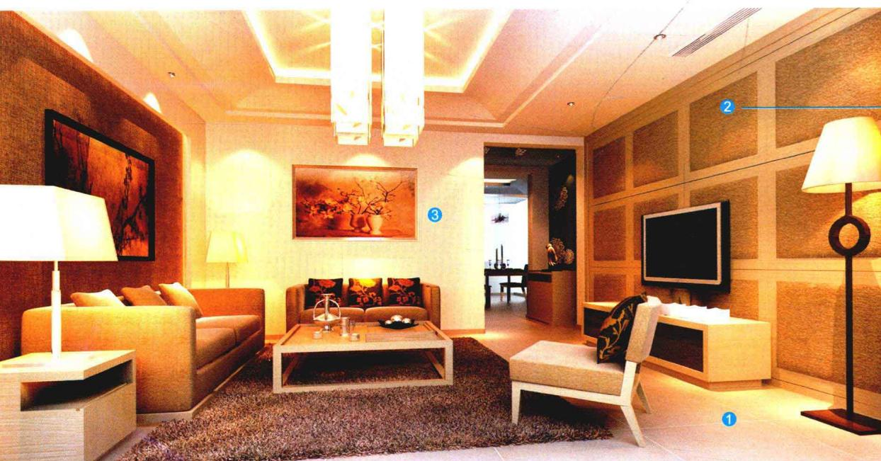
» 按照设计图纸用木工板做出墙面上壁纸的收边线条，贴装饰面板后刷油漆。剩余墙面满刮腻子，打磨光滑，刷一层基膜，用环保白乳胶将壁纸固定在墙面上。
