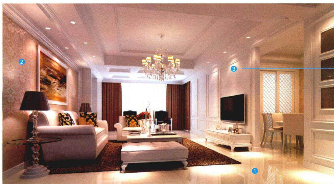
» 电视背景墙面用木工板打底，用木工板及硅酸钙板做出设计图上的立体造型，整个墙面满刮一遍腻子，用砂纸打磨光滑，刷一遍底漆、两遍面漆。
