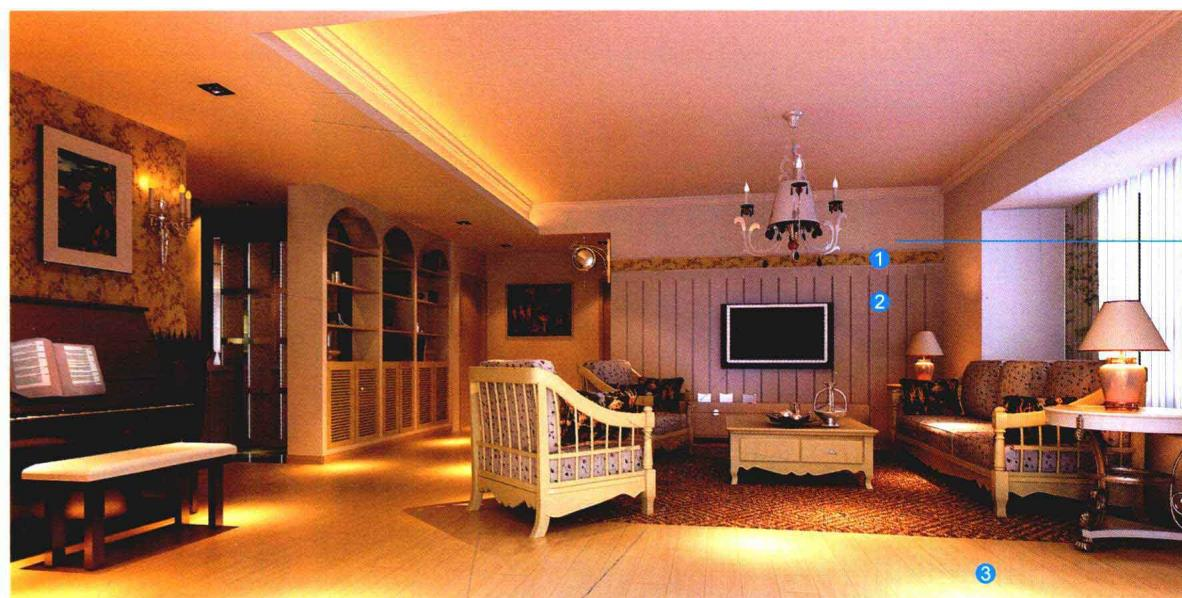
» 按照设计图纸在电视背景墙面上做出造型，满刮腻子，用砂纸打磨光滑，刷底漆、面漆；刷一层基膜后贴壁纸。
