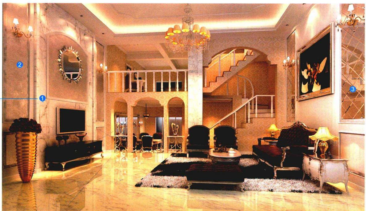
» 沙发背景墙面用木工板做出设计图上的造型，整个墙面满刮腻子，打磨光滑，刷底漆、面漆，用AB胶将镜面粘贴固定在底板上。
