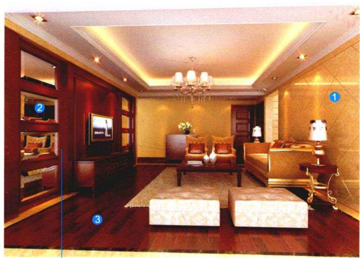
» 剩余墙面用木工板做出设计图上的造型，贴装饰面板后刷油漆，用玻璃胶将镜面固定在底板上。
