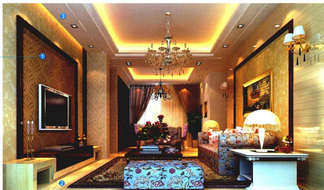
》》用木工板在墙面上做出设计图上的造型，贴装饰面板后刷油漆。剩余墙面满刮腻子，用砂纸打磨光滑，刷一遍底漆、两遍面漆，贴壁纸的基层需刷一层基膜，用环保白乳胶配合专业壁纸粉将壁纸固定在墙面上。
