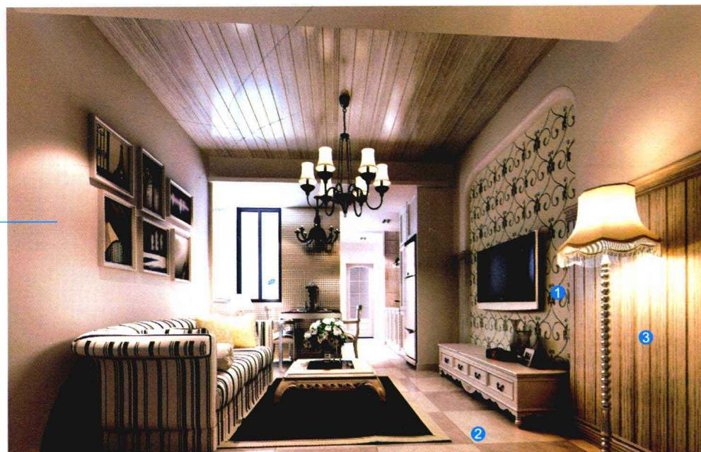
》》根据设计图纸用木工板在电视背景墙面上做出弧形造型，将复合实木地板直接用地板钉固定在墙面上。剩余墙面满刮腻子，打磨光滑，刷一层基膜后贴壁纸，白色部分刷一遍底漆、两遍面漆。
