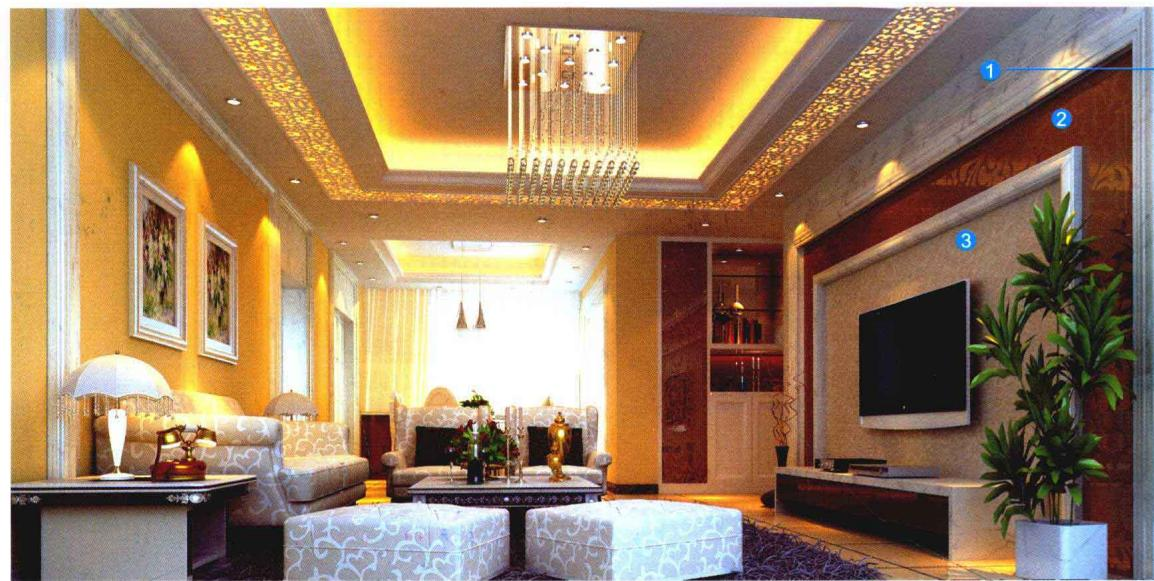
» 电视背景墙面用水泥砂浆找平，用点挂的方式将爵士白大理石固定在墙面上。镜面基层用木工板打底，用粘贴固定的方式将其固定在底板上，剩余墙面满用环保白乳胶配合专业壁纸粉将壁纸固定在墙面上。
