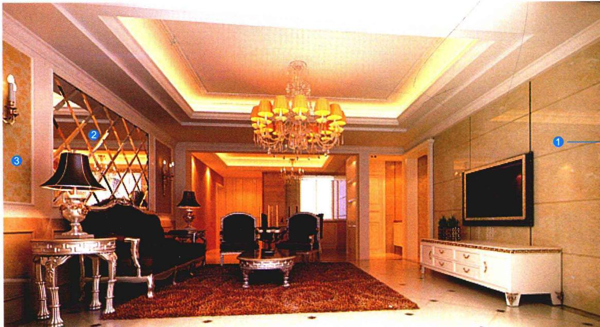
» 将仿古砖按照设计需要倒角，用水泥砂浆以湿贴的方式将其固定在墙面上，最后用专业的勾缝剂填缝，清洁好砖表面。
