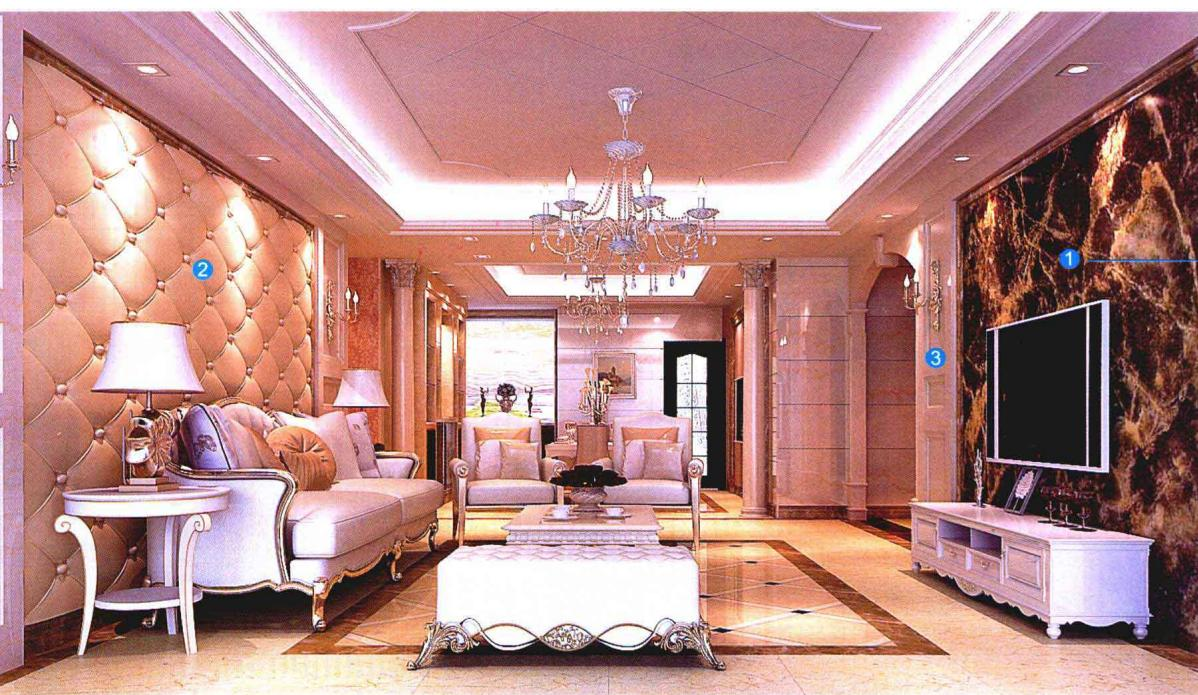
» 沙发背景墙面用水泥砂浆找平,用干挂的方式将石材固定在墙面上,用勾缝剂填缝;剩余墙面用木工板打底,用蚊钉及胶水将成品软包固定在底板上。
