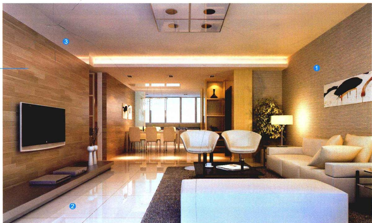
» 电视背景墙面用水泥砂浆找平，将复合实木地板直接钉在墙面上。或者墙面上满刮腻子，打磨光滑，刷一层基膜，用仿木地板图案的壁纸饰面，也可以达到同样的效果。
