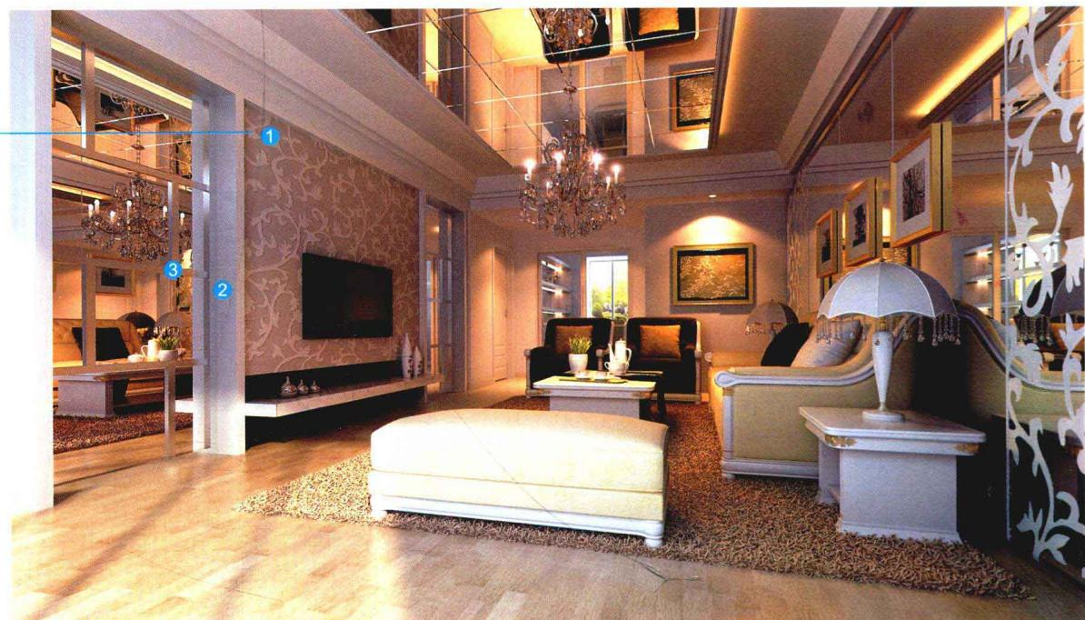
» 用木工板做出电视背景墙面上的层架，贴装饰面板后刷油漆，剩余墙面满刮腻子，打磨光滑，刷一层基膜，用环保白乳胶将壁纸固定在墙面上。黑镜的基层用木工板打底，以粘贴固定的方式将其固定在底板上。
