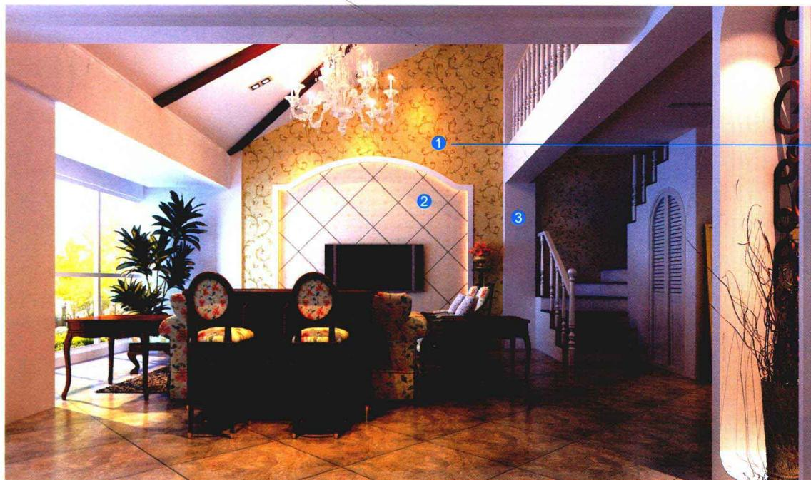
» 按设计图在墙面上弹线，确定仿古砖的位置，用水泥砂浆以湿贴的方式将其固定在墙面上，用黑色的勾缝剂填缝。用木工板做出灯带的造型，剩余墙面满刮腻子，打磨光滑，刷一层基膜后贴壁纸。
