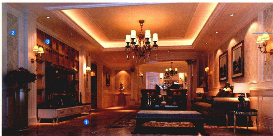
》》按照设计用木工板在墙面上做出设计图上的造型，顶部用成品石膏角线装饰，整个墙面满刮腻子，用砂纸打磨光滑，刷一遍底漆、两遍面漆。部分墙面用有色乳胶漆装饰；用环保包乳胶配合专业壁纸粉将壁纸固定在墙面上。
