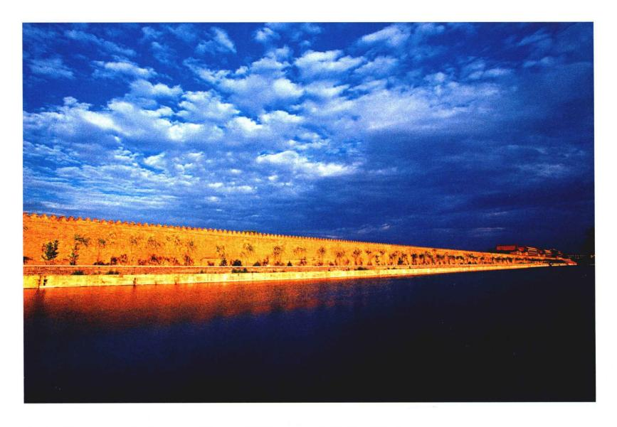
城墙与护城河 紫禁城城墙为矩形,南北长961米,东西宽753米,城墙高9.90米,墙体底部为8.6米,顶部为6.66米,呈下宽上窄的梯形,以特制青砖筑成。护城河宽52米,深6米,全长3800米,围城环绕,是皇宫外围的防御设施。(上图)
