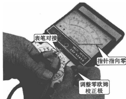
图 1-2 测量电阻零欧姆校正
