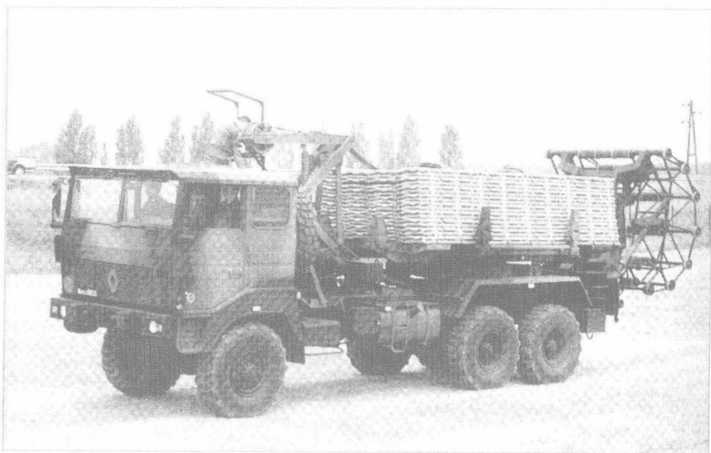
图 1.5 德国铝质六角板折叠式路面
