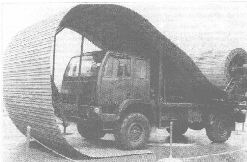
图 1.7 巴基斯坦 30t 级冲击型路面器材
