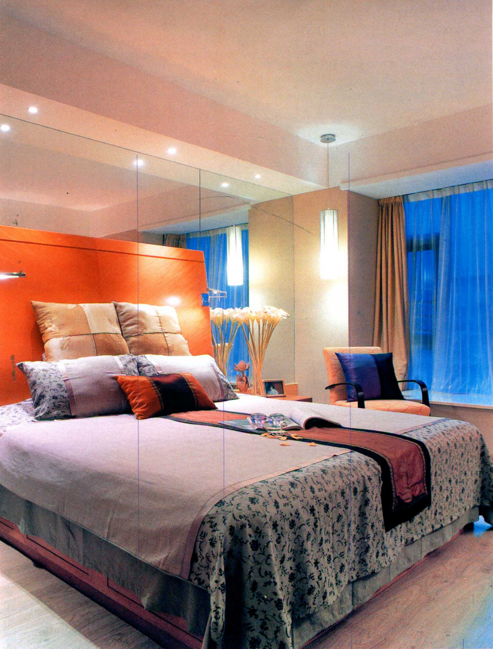
轻钢龙骨石膏板吊顶 银镜 白色乳胶漆 复合地板
