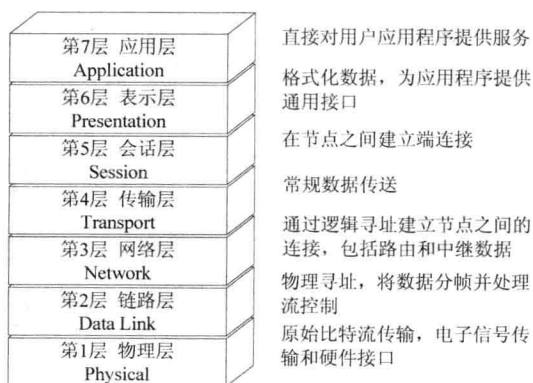
图 1-2 OSI 参考模型的分层结构
