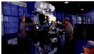
淳安县罐头食品厂 空罐高频电阻焊自动生产线
