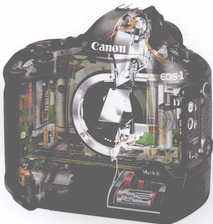
Canon EOS-1D Mark III 相机内部构造剖析图
