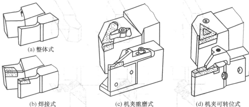
图 1-14 车刀的结构形式
