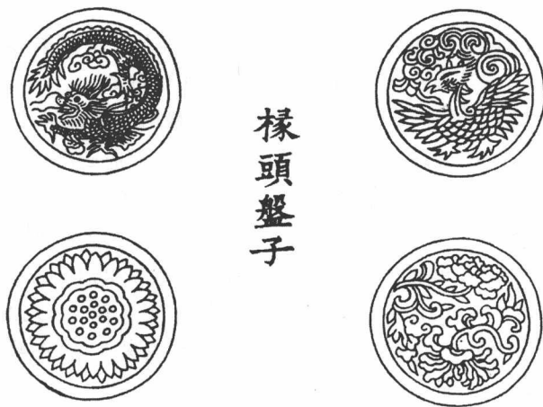
图7 《营造法式》中的椽头盘子图(引自陶本《营造法式》第32卷雕木作制度图样)
