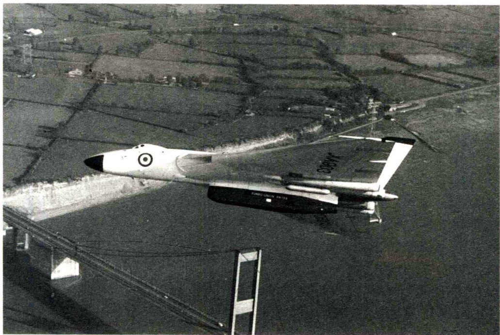
上图：“火神”轰炸机XA903被用来测试RB 199发动机，其机身与“狂风”战斗机相同，进气口和输送管也一样，右舷进气口之前的前机身外形也完全仿制了“狂风”战斗机。在最初几次飞行中该机左翼下带有一个检测仪表舱。
