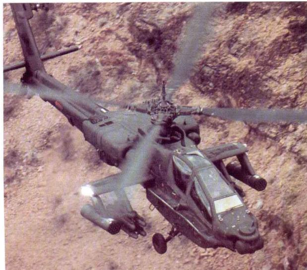
**武器装备：**AH-64“阿帕奇”装有1门M230 30mm机关炮，其炮弹可击穿数厘米厚装甲。可挂载武器有AGM-114“地狱火”导弹、AIM-92“刺针”导弹、AGM-122“侧投”导弹、AIM-9“响尾蛇”导弹、BGM-71“陶”式导弹(BGM-71 TOW)以及Hydra 70 FFAR火箭弹。
