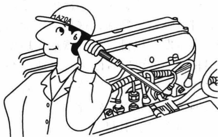
图1-3 喷油器听诊检测图
