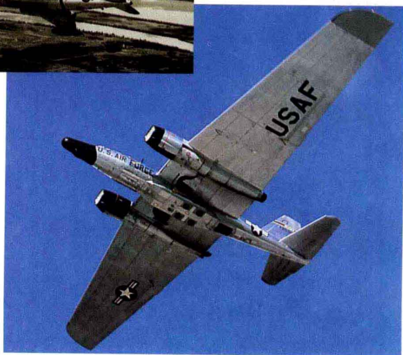
右图：RB-57D长长的机翼产生了杰出的高空性能。不幸的是，飞机遭受了机翼疲劳裂缝的问题。
