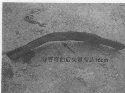
a)发生弯曲变形的部分导管
