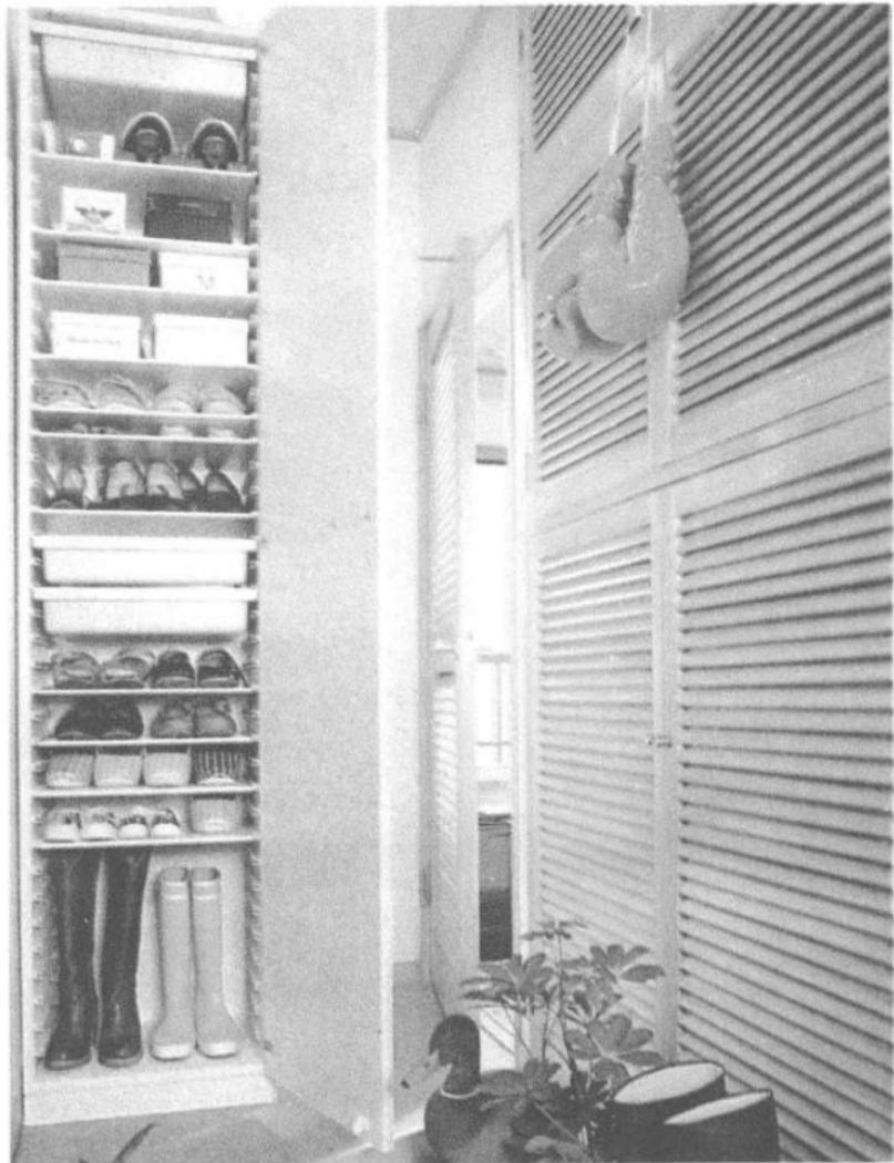
◆位於廳房一角的大容量鞋架。特點是隔板是活動的，可以根據需要變動隔板高度。這種櫃架，最好利用凹角位建造。設計圖見P.23。
