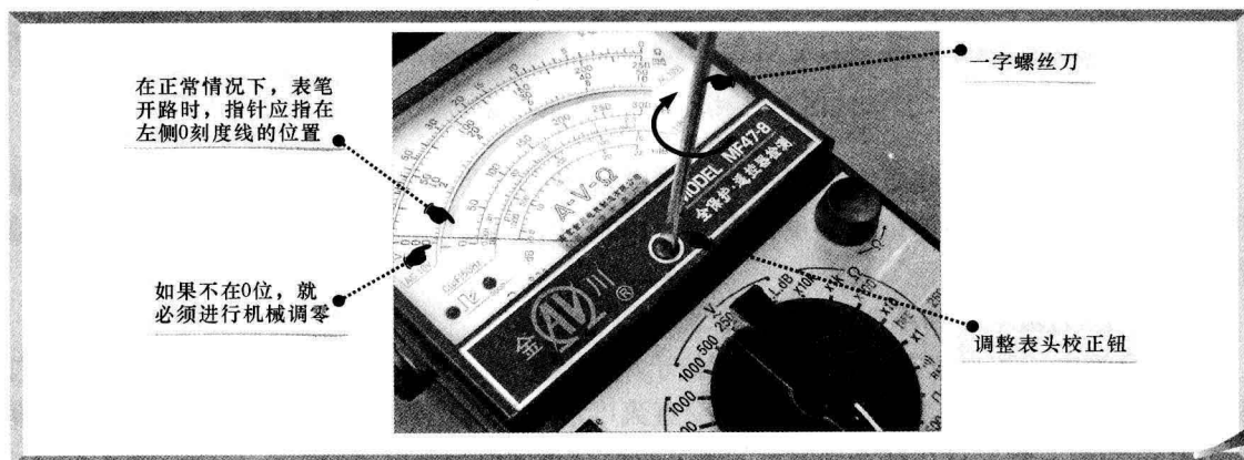
图 1-3 典型指针式万用表的表头校正螺钉
